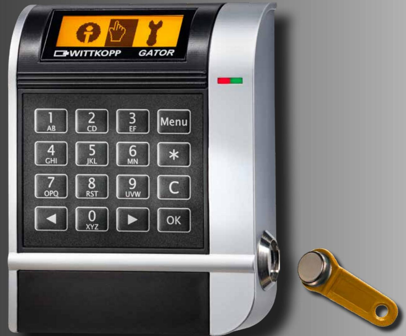
Zur Übertragung sämtlicher Programmierungen und Vorgänge wird der iButton an den Leser gehalten
